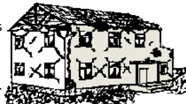
Grado 5: Destrucción (daños estructurales muy graves). Colapso total o casi total.
